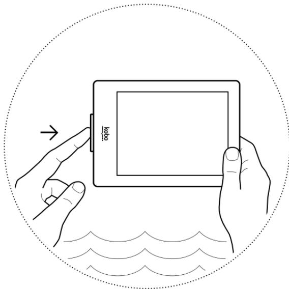
Votre liseuse est équipée d'un cache de port sur sa partie inférieure afin de protéger les fentes Micro USB et Micro SD contre la pénétration d'eau. Pour rendre votre liseuse étanche, vous devez fermer les capuchons de port, comme dans l'illustration ci-dessus. Si le capuchon de port n'est pas bien fermé, votre liseuse sera endommagée si elle est plongée dans l'eau ou utilisée dans des zones très humides, et elle ne sera plus couverte par la garantie.
