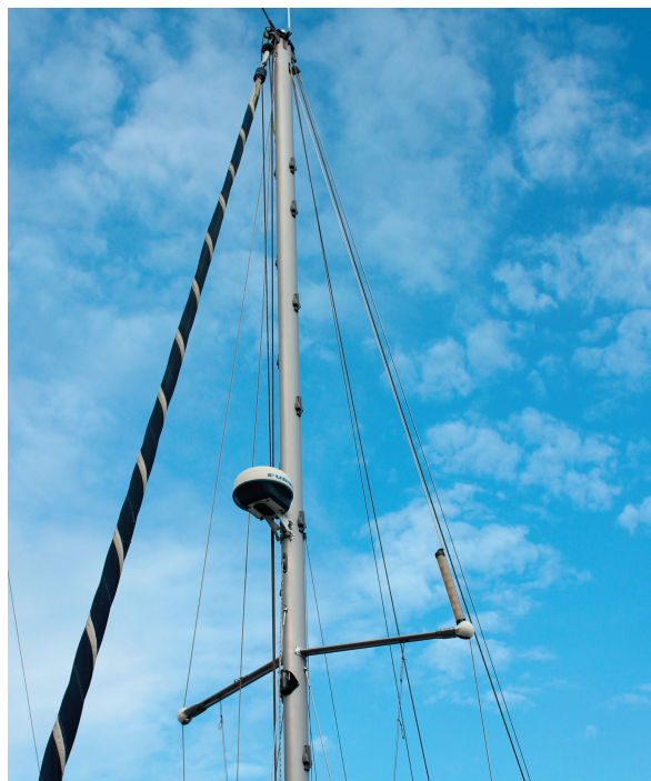
Le mât est soutenu par les haubans, le pataras et les étais. Les barres latérales sont des barres de flèche.
