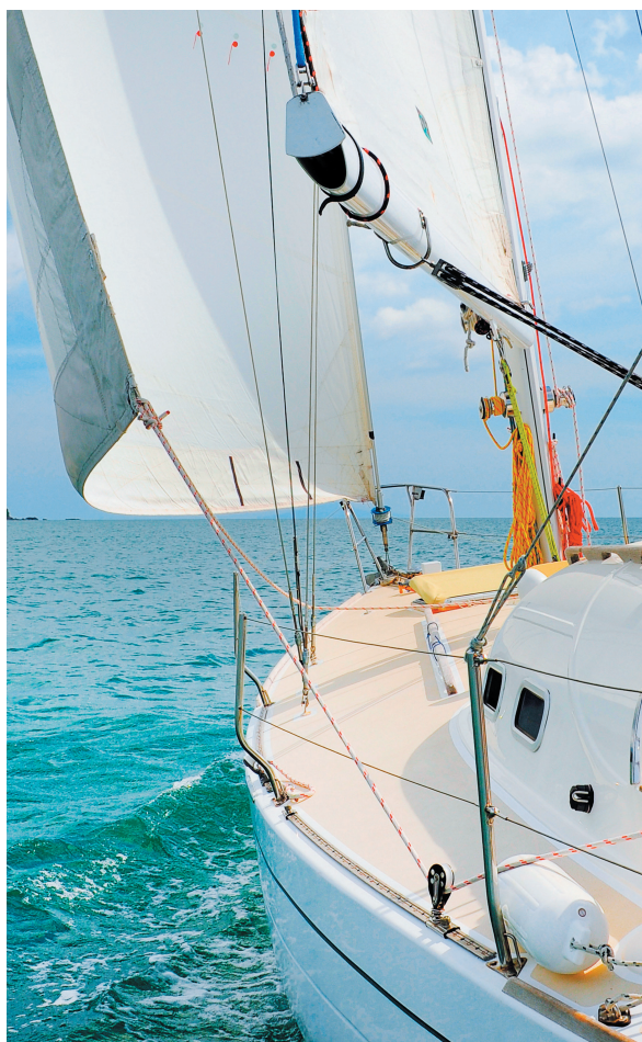
L'écoute de la voile d'avant fixée sur le chariot d'écoute est ajustée dans sa tension.
