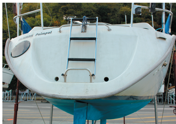
Forme de jupe arrière pour la poupe d'un bateau.
