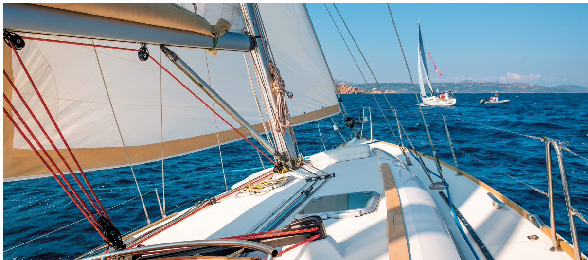
En rouge sous la bôme, c'est le palan d'écoute de la grand-voile. En gris, derrière, c'est le hale-bas.
