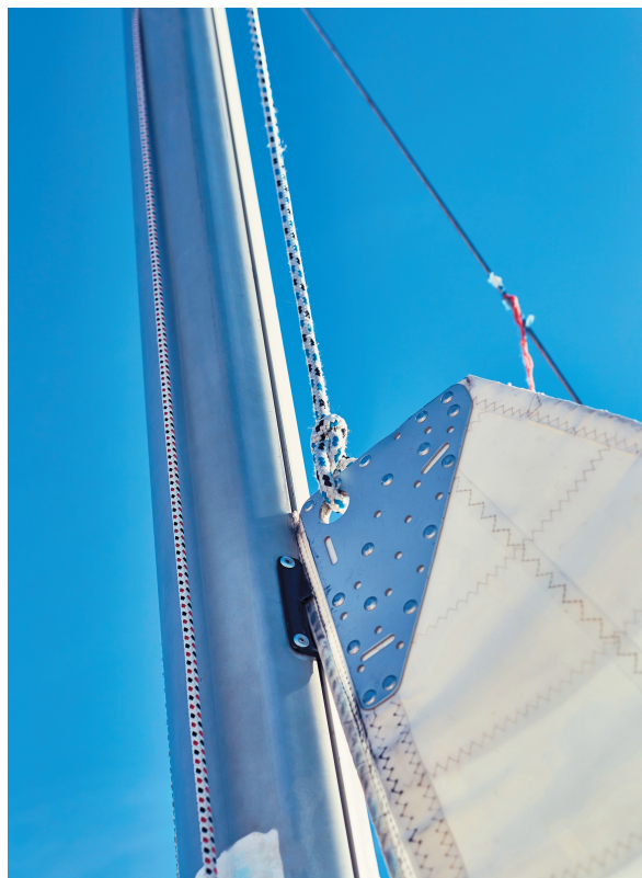
La grand-voile est grée dans le rail du mât. La drisse est frappée sur le point de drisse.
