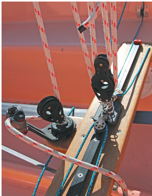
Les chariots d'écoute glissent sur la barre d'écoute, qui peut être située dans le cockpit.
