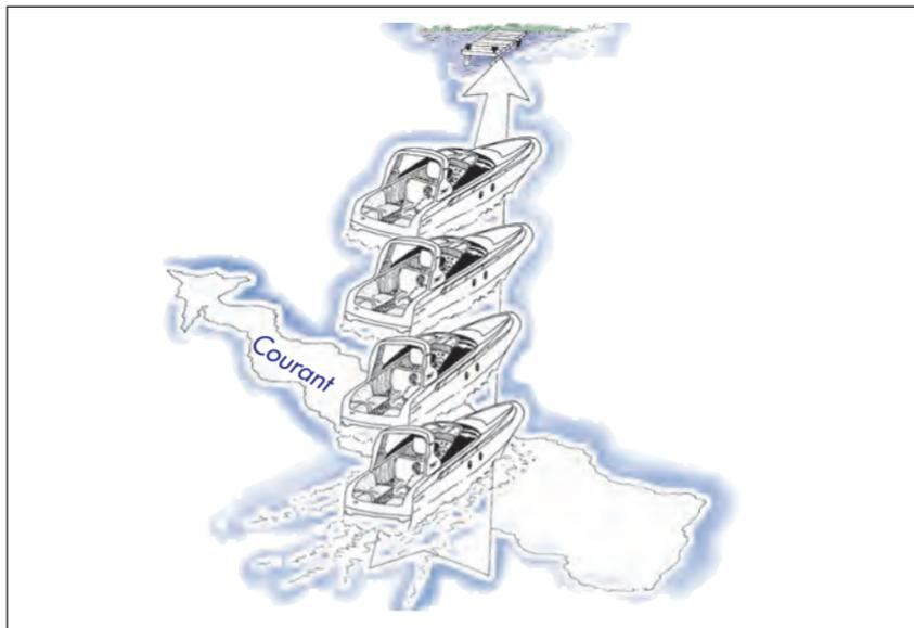
*La trajectoire suivie par le navire ne correspond pas à la direction montrée par l'étrave (ici à cause du courant).*
