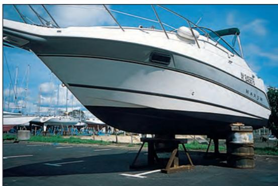
*La carène pénètre peu dans l'eau (bateau léger) ; aucune quille ou aileron ne vient limiter le déplacement latéral.*
