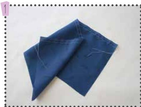
1 Sur l'endroit du tissu, piquez au point droit deux fils de fronces parallèles au bord du tissu. Le premier fil de fronces se situe à 0,7 cm du bord, le deuxième à 1,2 cm du bord. Pour cela, utilisez le point droit de votre machine puis réglez la longueur du point au maximum et la tension du fil au minimum.
