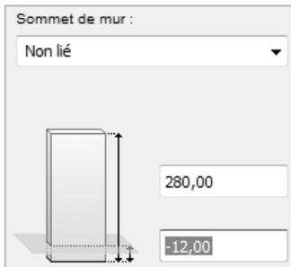
Si vous avez choisi un étage, vous saisissez dans les champs **Décalage supérieur d'étage supérieur lié** et **Décalage inférieur d'étage d'implantation** respectivement la hauteur de dépassement de l'élément par rapport à la hauteur d'étage et la profondeur à laquelle le mur s'implante dans l'étage du dessous. Vous ne pouvez pas dans ce cas indiquer la hauteur du mur. Elle dépend uniquement de la hauteur d'étage.
