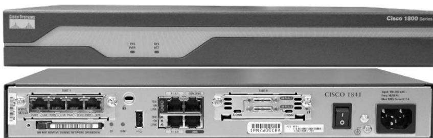
LED et ports d'un routeur Cisco 1841
