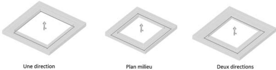
**Une direction** : l'extrusion est définie dans une direction (vers l'extérieur) à partir de l'esquisse.
