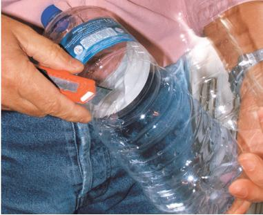
**1** Une bouteille en plastique munie de son bouchon fait un excellent récipient pour la vidange d'un radiateur. Dans le sens de la longueur, découpez la partie supérieure au cutter.
