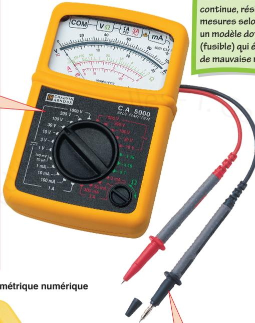
Les multimètres permettent d'effectuer un grand nombre de mesures : tension alternative ou continue, intensité alternative ou continue, résistance et encore bien d'autres mesures selon les modèles. Préférez toujours un modèle doté d'une protection interne (fusible) qui évite de détruire l'appareil en cas de mauvaise manipulation.
