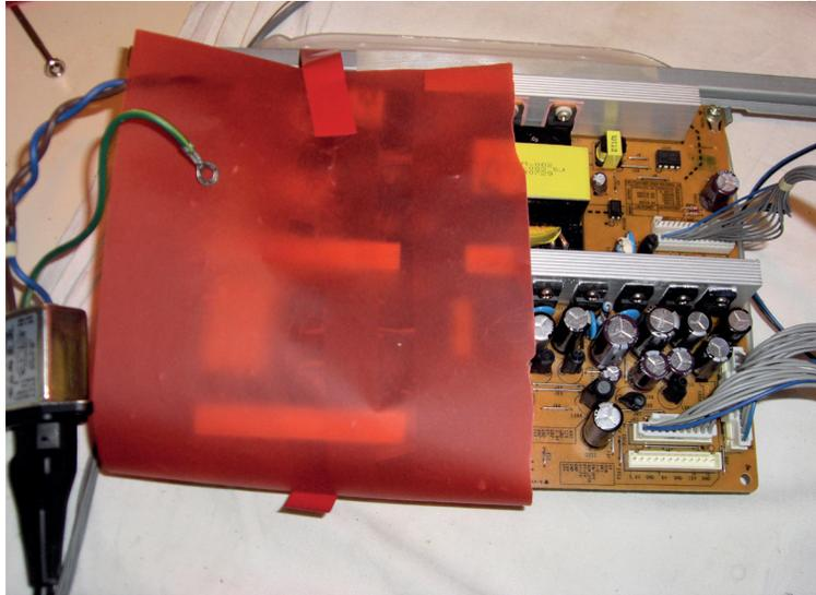
Figure 1-1. Protection d'une alimentation en cours de dépannage
