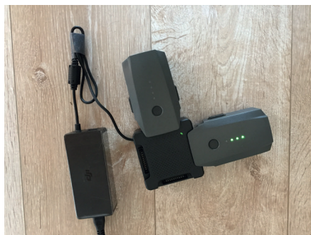
Figure 1-13. Le nombre de voyants allumés (de 1 à 4) indique le niveau de charge.
