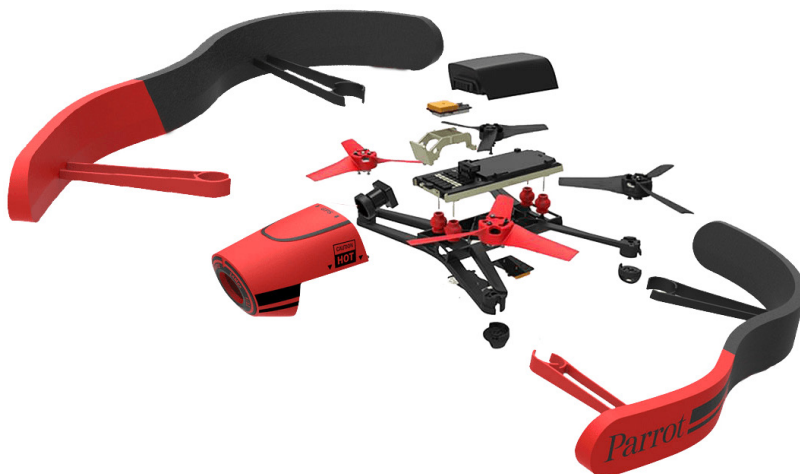
Figure 1-5. Anatomie d'un Bebop de Parrot : l'appareil partage de nombreux points communs avec un smartphone.
