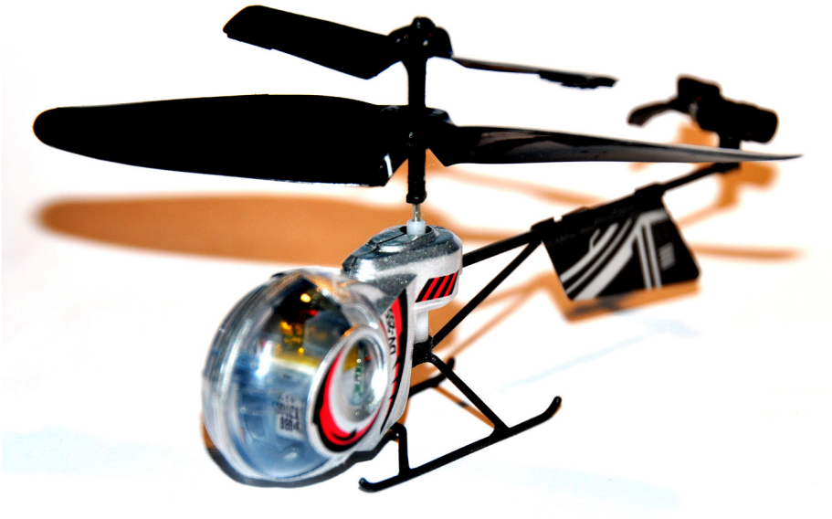
Figure 1-6. Le Atom de Picooz, un nano hélicoptère piloté – avec difficulté – avec une radiocommande en infrarouge
