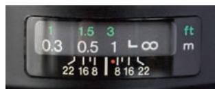
Si l'on souhaite utiliser cette échelle avec un appareil à capteur APS-C, il faudra transposer sa lecture à une valeur supérieure d'un cran à l'ouverture réellement sélectionnée (soit ici f/22 pour une netteté estimée d'environ 0,4 m à l'infini) dans le but de compenser grossièrement la taille du capteur et son effet sur la profondeur de champ.
