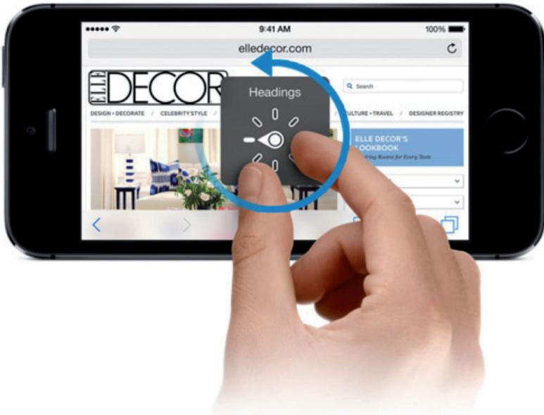
FIG 0.7 : Rotor de VoiceOver sur l'iPhone (<http://bkaprt.com/rrd/0-12/>)
