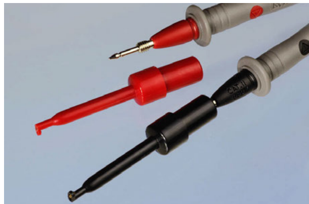
Figure I-8. Grippe-fils permettant aux pointes de touche de votre multimètre de s'accrocher à une connexion, vous évitant de devoir tenir les pointes de touche en place.
