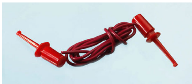
Figure I-12. Cordon ayant un grippe-fil à chaque extrémité, utile là où une pince crocodile pourrait provoquer un court-circuit avec un conducteur voisin.
