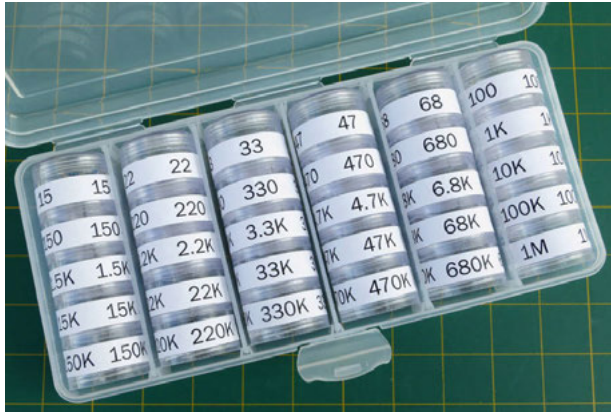
Figure I-14. Une boîte à perles légèrement plus grande convient pour les résistances si leurs fils sont réduits en longueur.
