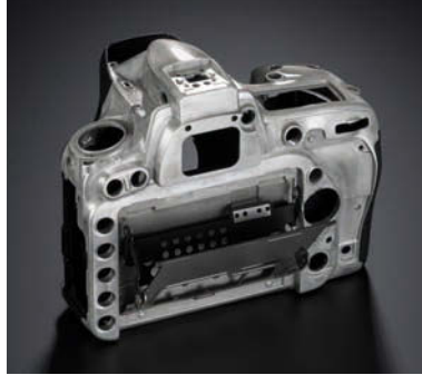
Figure 1.2 Le châssis du D750 est conçu autour d'un squelette en alliage de magnésium et d'une façade en fibre de carbone, respectivement en gris clair et gris foncé sur les deux images. (Documents Nikon)
