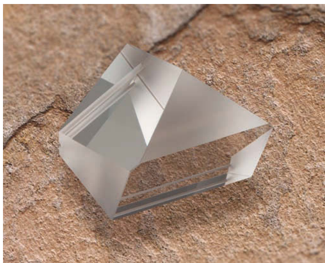
Figure 1.8 Le pentaprisme qui équipe le D750 lui confère une image de visée claire et bien lisible, nettement supérieure à celle affichée par les reflex d'entrée de gamme qui font appel à un jeu de pentamiroirs.
