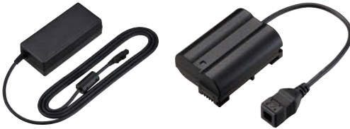
Figure 1.19 Avec le D750, l'alimentation secteur EH-5b (à gauche) doit être associée au coupleur EP-5B (à droite) dont le connecteur se branche dans le logement de l'accumulateur de l'appareil photo. En cas de séjour à l'étranger, songez à emporter avec vous un adaptateur de prise. (Documents Nikon)
