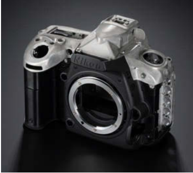
Figure 1.2 Le châssis du D750 est conçu autour d'un squelette en alliage de magnésium et d'une façade en fibre de carbone, respectivement en gris clair et gris foncé sur les deux images. (Documents Nikon)
