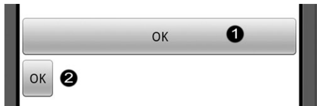
Figure 13-7 L'attribut layout_width est utilisé pour modifier la largeur d'un bouton.
