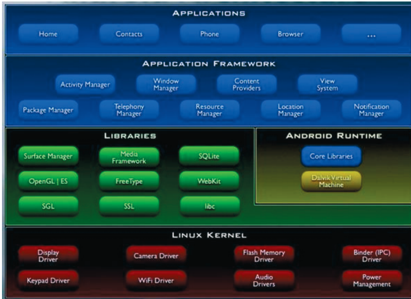
FIGURE 1-5 La pile des différents composants d'un système d'exploitation Android, reposant sur un noyau linux.
