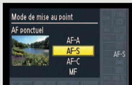
Avec le mode autofocus Ponctuel, quand vous appuyez sur le bouton déclencheur à mi-course, la mise au point est effectuée puis elle est aussitôt verrouillée. L'autofocus ne réalise donc le point qu'une fois par vue, d'où le nom « One Shot » chez Canon. Ce mode est donc adapté aux prises de vues comportant des objets ou des personnes immobiles.
