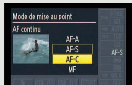
Le mode Continu est mieux adapté à la mise au point continue sur un objet en mouvement. Tant que vous laissez le doigt appuyé à mi-course sur le bouton déclencheur, l'autofocus évalue la mise au point en permanence, et ne rate pas les objets en mouvement. Le mode Continu est indispensable en mode Rafale pour réajuster la mise au point entre les vues.
