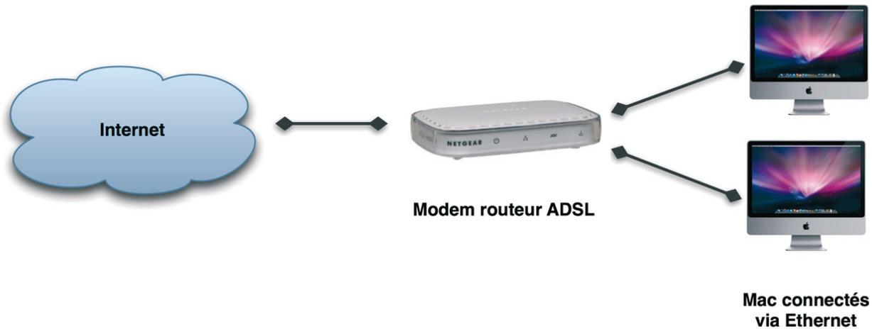
**Figure 11-2** Avec un modem routeur, les ordinateurs exploitent la même connexion à Internet.
