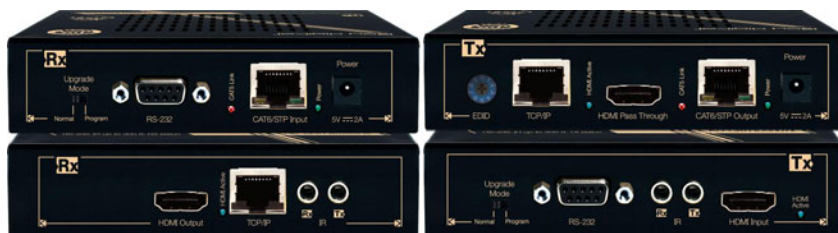
Figure 2.20 Distribution vidéo haute définition sur câblage VDI. Le signal vidéo 1080p, le report de télécommande infrarouge et les données de pilotage RS232 sont transmis sur une distance de 100 mètres par l'intermédiaire d'un seul câble informatique grade 3 (source Key Digital)
