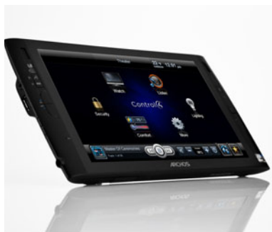
Figure 2.28 Écran tactile permettant de simplifier l'utilisation du home cinéma en remplaçant toutes les télécommandes et en automatisant le déclenchement de scénarios prédéfinis (source Archos/Control4)
