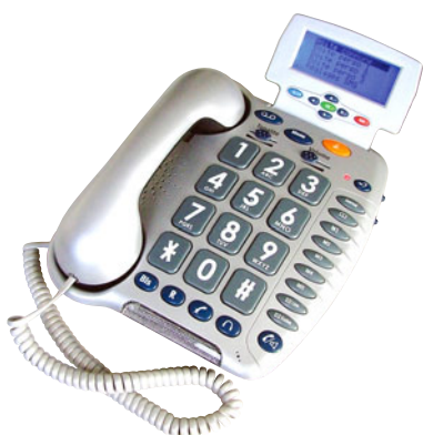
Figure 1.11 L'ergonomie élémentaire de ce téléphone répond aux besoins de tous les utilisateurs qui souhaitent des équipements simples et conviviaux. Avec ses grosses touches, ses raccourcis et son voyant lumineux il est particulièrement adapté aux personnes âgées ou handicapées (source France Télécom)
