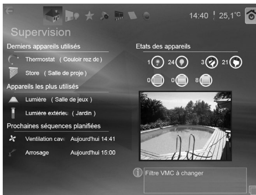
Figure 1.12 L'écran permet de garder un œil sur la piscine, d'accéder aux informations de température et de sécurité ainsi que d'être prévenu en cas de dysfonctionnement ou d'informations de maintenance (source Hager)
