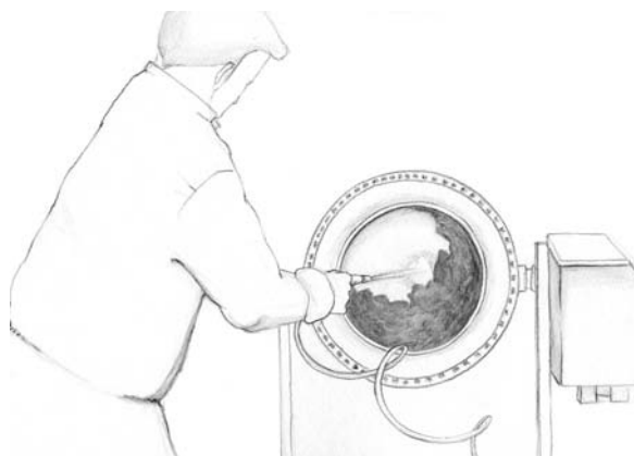
3. Hydratation du mélange au jet d'eau.
