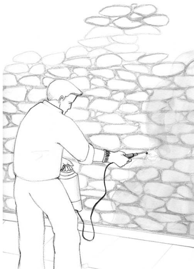
1. Aspersions du mur au pulvérisateur.
