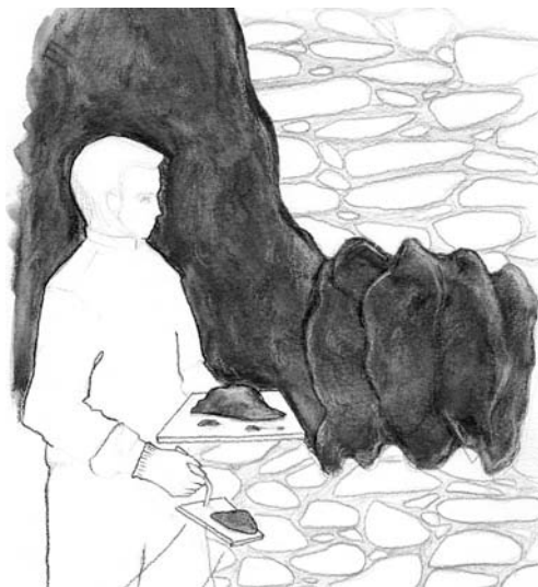
2. Recouvrement du support par chevauchement des truillées de mortier.
