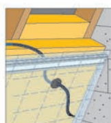
Utilisation d'un œillet adhésif sur un conduit électrique
