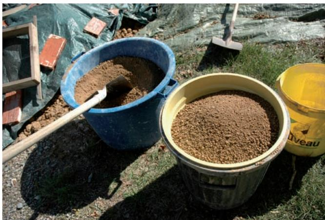
*Dans le seau bleu, une terre tamisée fin grâce au tamis n° 8 ou 10 posé à droite dans un second seau de terre tamisée.*
