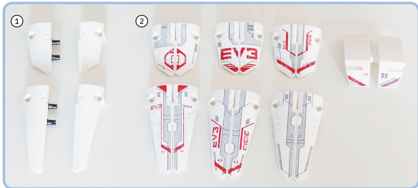
Figure 1-5 : Pour placer parfaitement les autocollants sur les panneaux, reliez tout d'abord les pièces complémentaires à l'aide de deux chevilles noires. L'alignement des autocollants sera ainsi plus facile. Lorsque vous aurez terminé, retirez les chevilles.
