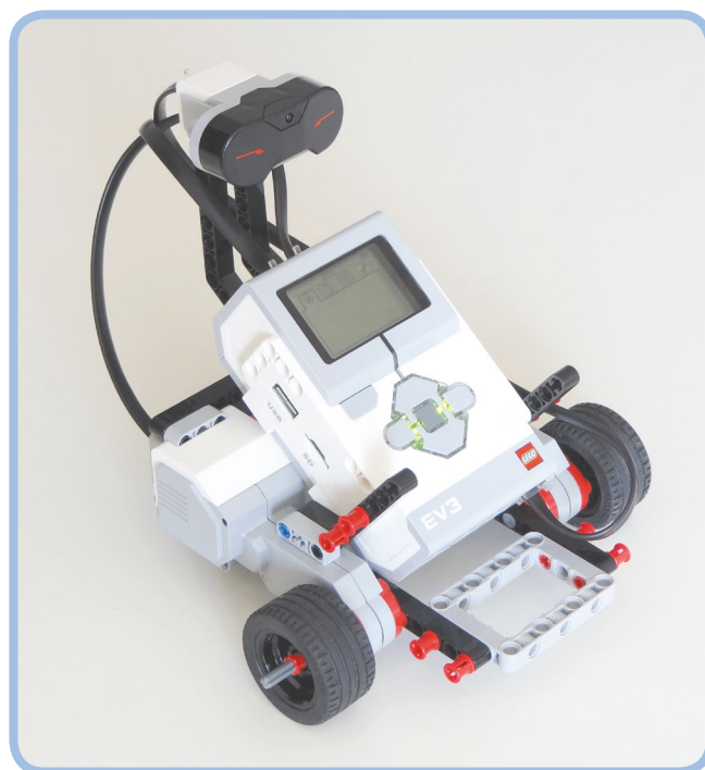
Figure 2-1 : EXPLOR3R se déplace grâce à deux roues à l'avant et une roue d'appui à l'arrière.
