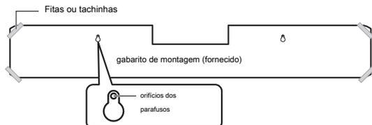
2 Retire o gabarito de montagem da parede, em seguida, instale comercialmente disponíveis parafusos (como ilustrado a seguir) nos pontos marcados na parede.
